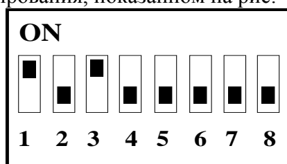
Рис. 4. Пример установки адреса БУЗ
