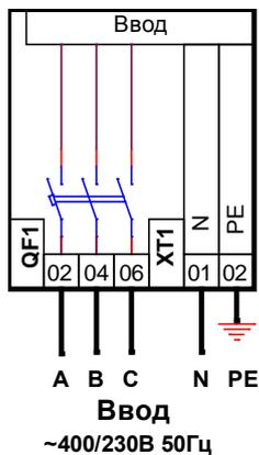
Фазные проводники электропитающего кабеля подключаются к нижним зажимам автоматического выключателя QF1.
