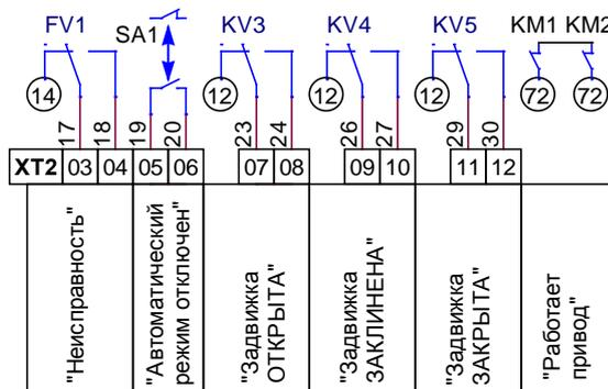
8. Для инвертирования сигнала "Автоматический режим отключён", необходимо отключить проводники 19 и 20 от нормально-открытого контакта переключателя, снять контакт с переключателя, установить на его место расположенный рядом резервный нормально-закрытый контакт, и подключить к нему проводники 19 и 20.
